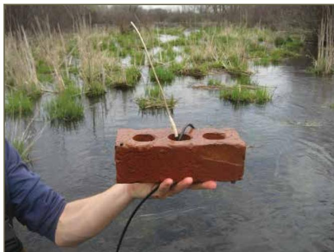
Photo 69. Récepteur-enregistreur de données passif utilisé pour consigner le passage des tortues dans un ponceau sur l'autoroute 24 ©K. Gunson
